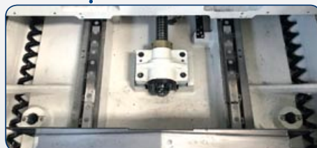
Doppie coclee centrali per evacuazione trucioli Central double screws for chip removal
