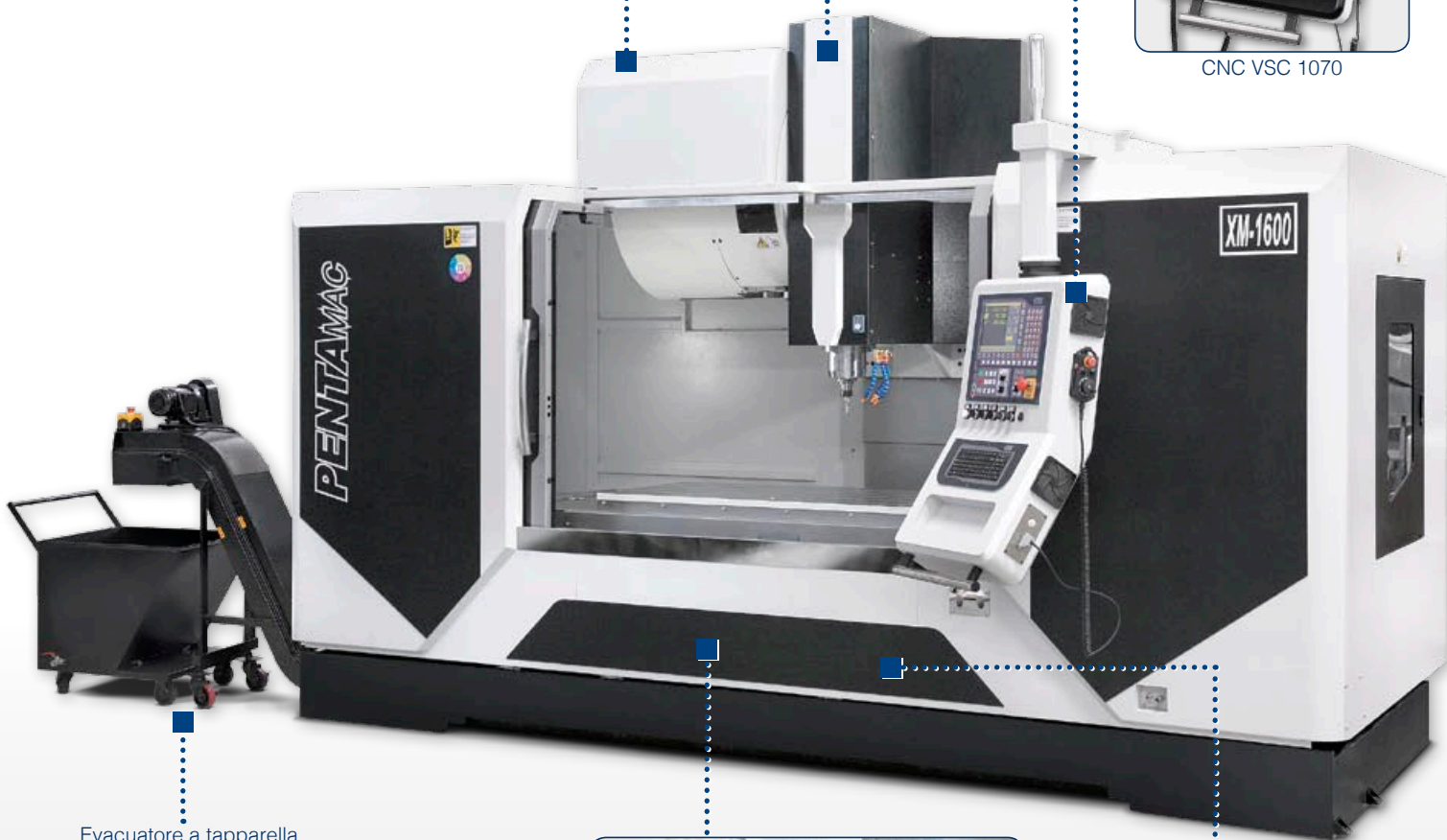
Evacuatore a tapparella uscita sinistra o destra. Steel belt chip conv.
