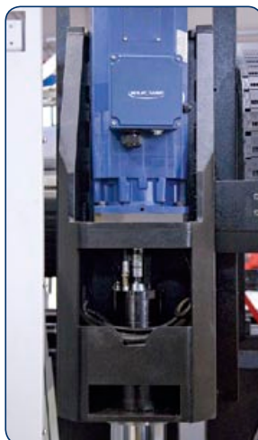
MOTORE DIRECT DRIVE, 10.000 RPM + unità raffreddamento mandrino Cooling Spindle system
