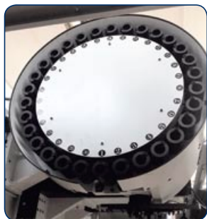
Magazzino Utensili 30 posizioni ARM TYPE ATC 30 positions (random)
