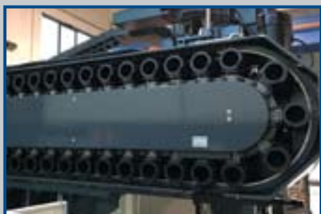
Cambio utensile CHAIN TYPE 40 posiz./ISO 50 Chain type ATC 40 pos. / ISO 50
