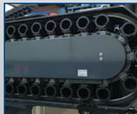
Cambio utensile CHAIN TYPE 40 posiz./ISO 50 Chain type ATC 40 pos. / ISO 50
