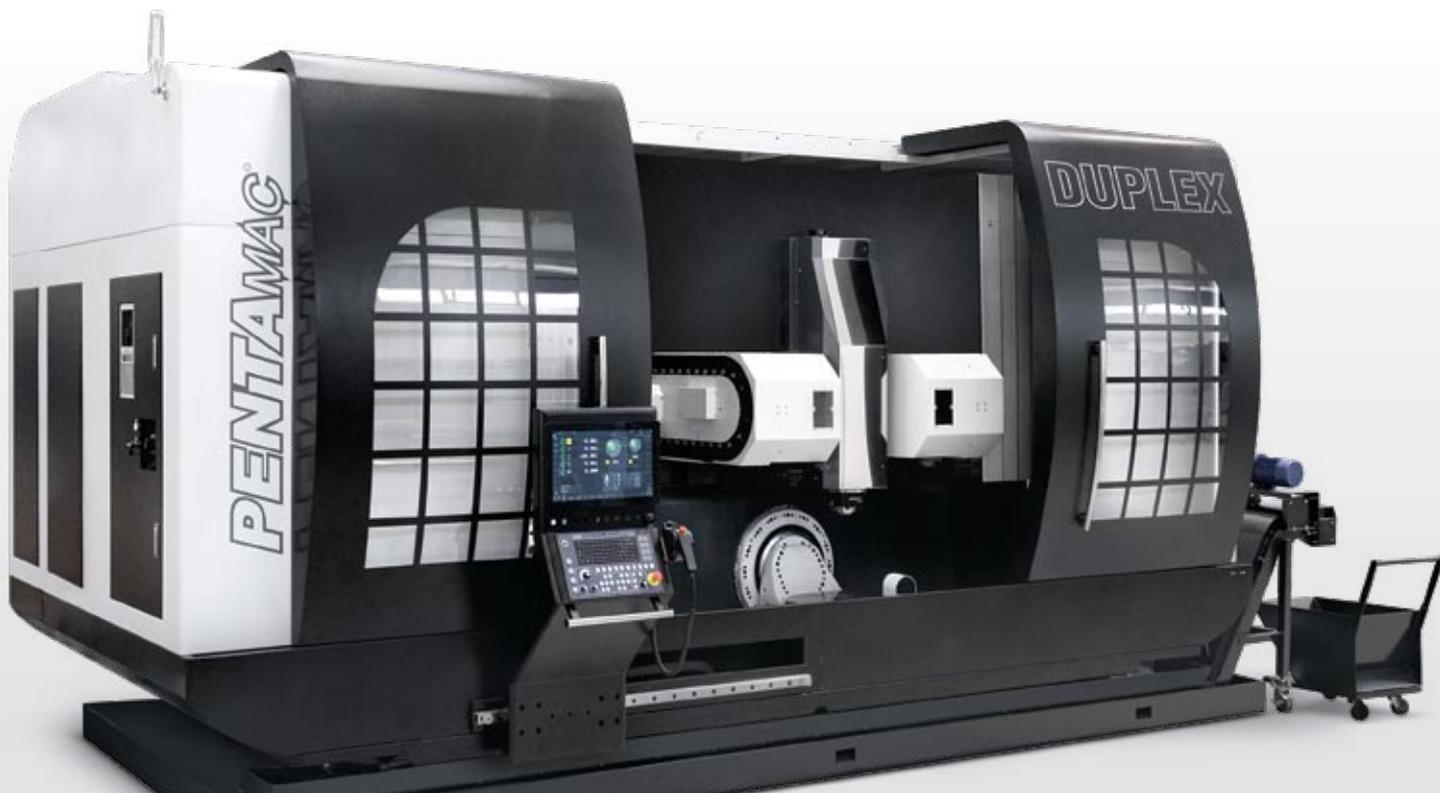
▲ Nella versione **ST**, la macchina è configurata con una tavola roto-basculante a 5 assi in continuo e, sul lato opposto, con una tavola ortogonale fissa di 1.300 x 700 mm ove eseguire lavorazioni standard a tre assi.
