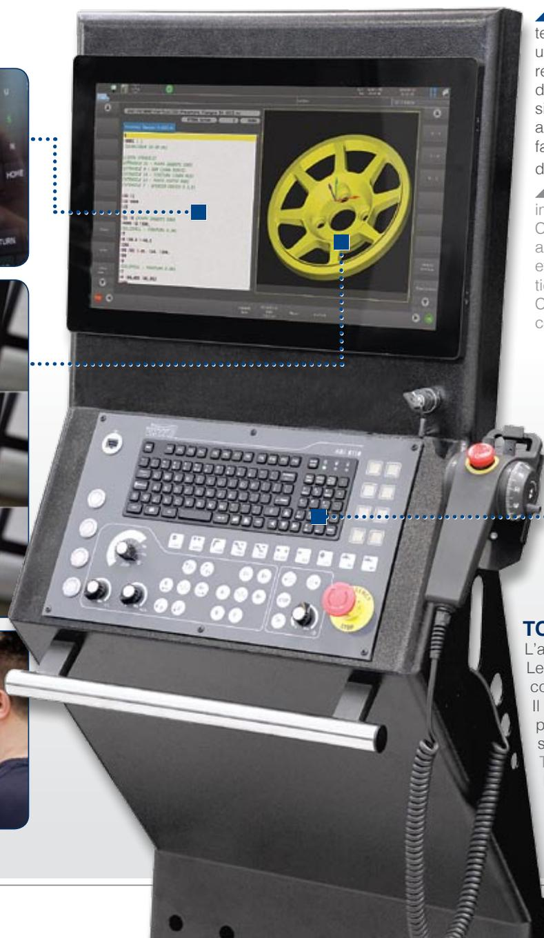
▲ Il nuovo CNC Visel VISPLUS-210 integra le funzioni classiche del CNC con un sistema di gestione dati e processi relativi a: produttività, controllo eventi e diagnostiche macchina. L'operatività è simile ad un tablet. La connettività, con accesso diretto a tutti i dati macchina, favorisce l'integrazione in aziende pre-disposte ad Industry 4.0.
